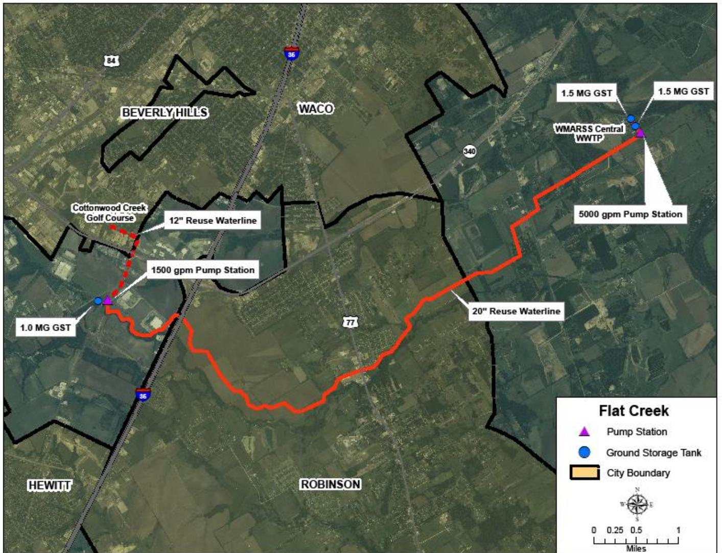
Figure 1. WMARSS Flat Creek Reuse
