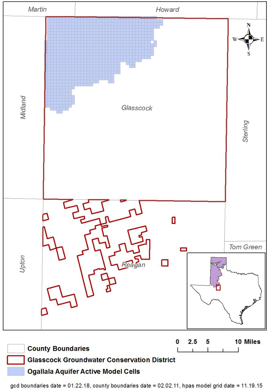
**FIGURE 2. AREA OF THE GROUNDWATER AVAILABILITY MODEL FOR THE OGALLALA AQUIFER FROM WHICH THE INFORMATION IN TABLE 2 WAS EXTRACTED (THE AQUIFER SYSTEM EXTENT WITHIN THE DISTRICT BOUNDARY).**
