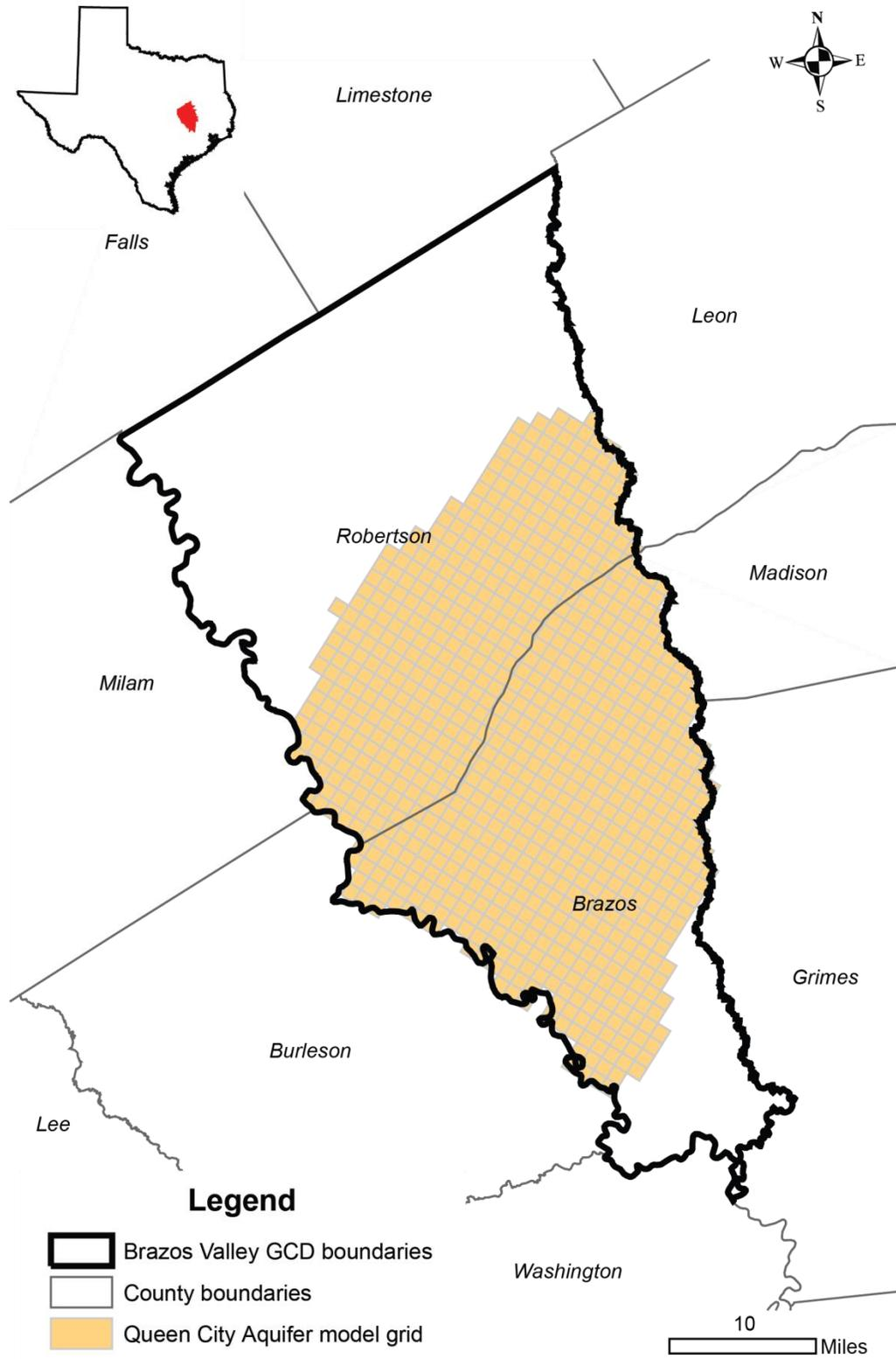
**FIGURE 2: AREA OF THE GROUNDWATER AVAILABILITY MODEL FOR THE QUEEN CITY AQUIFER FROM WHICH THE INFORMATION IN TABLE 2 WAS EXTRACTED (THE QUEEN CITY AQUIFER EXTENT WITHIN THE DISTRICT BOUNDARY).**
